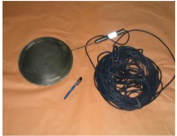
شکل (5) - تصویر سمت راست: فشارسنج - تصویر سمت چپ: ترک سنج یک
