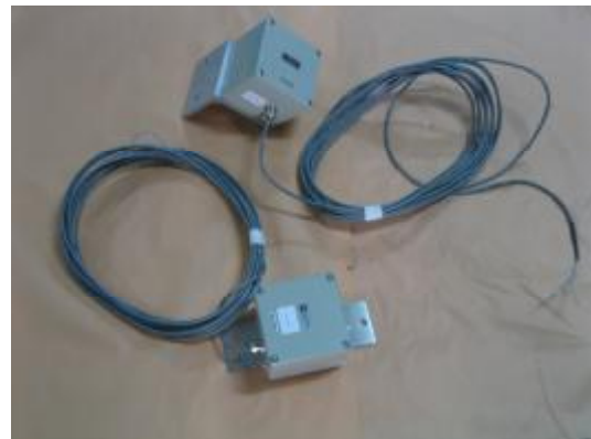
شکل (7) - تصویر سمت راست: انحراف سنج ها - تصویر سمت راست: دستگاه قرائت
