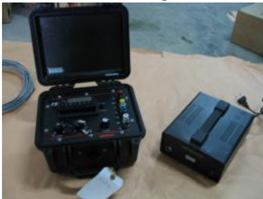
شکل (7) - تصویر سمت راست: انحراف سنج ها - تصویر سمت راست: دستگاه قرائت
