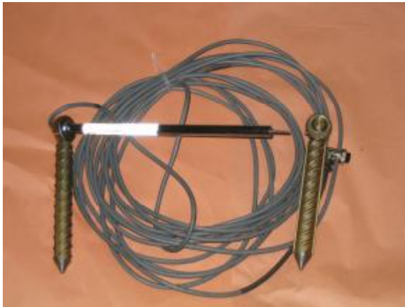
شکل (5) - تصویر سمت راست: فشارسنج - تصویر سمت چپ: ترک سنج یک
